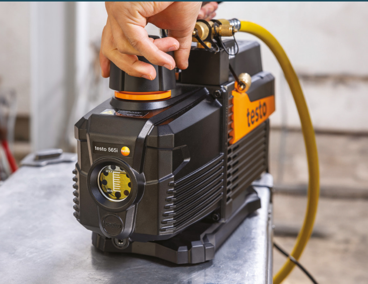
Einfacher Ölwechsel und Schauglas zur schnellen Bewertung des Ölstandes.
