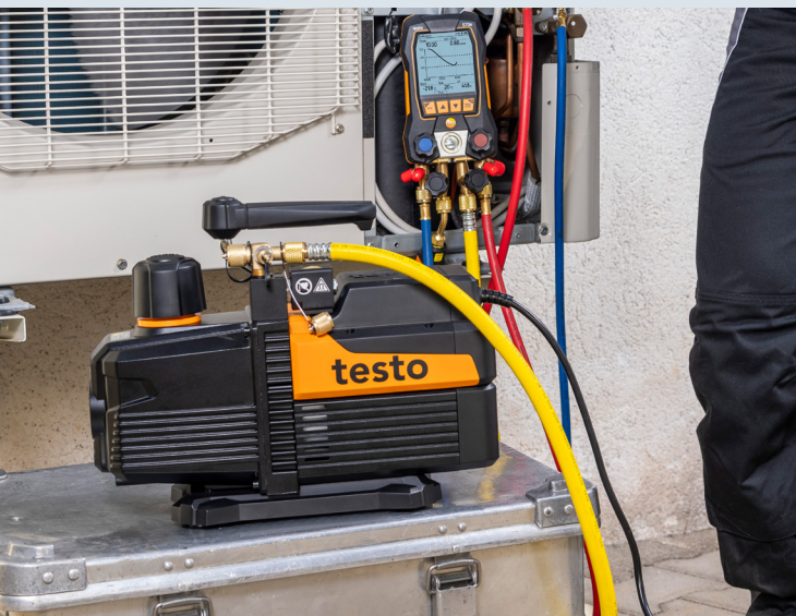
Rückschlagventil zur Vermeidung von Vakuumverlust bei Stromunterbrechung.
