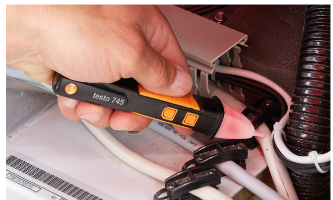
Der wasser- und staubdichte Spannungsprüfer testo 745 ist ein robuster und langlebiger Begleiter Ihres Arbeitsalltages.
