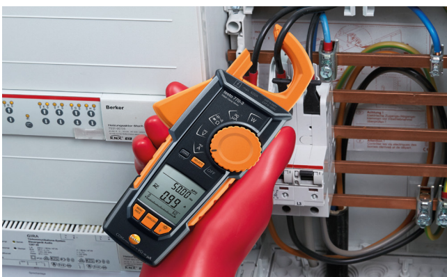
Kontaktlose Messungen an engliegenden Leitern gehen mit der Stromzange testo 770-3 einfach und sicher von der Hand: Ein Zangenschenkel ist komplett einfahrbar.
